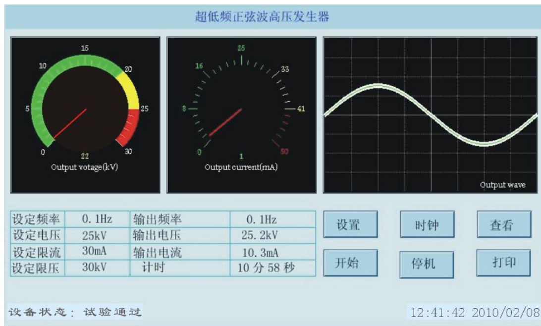
图 11 控制器提示试验通过
