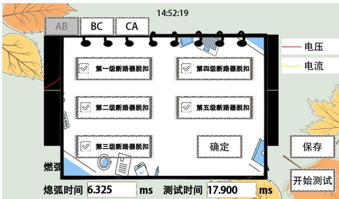
断路器跳闸后，根据实际跳闸情况，选择相应断路器脱扣选项。
