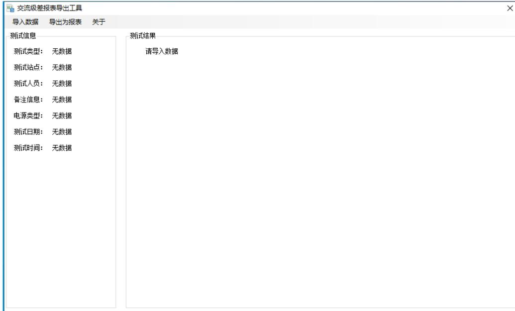
左侧用于显示测试基础信息，右侧显示具体的测试信息
