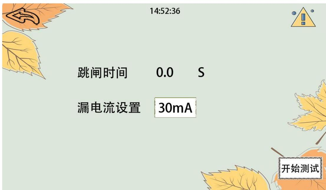
漏电流设置：可设置的漏电流分两档：30mA/300mA，可根据实际需求，设置相应漏电流档位。
