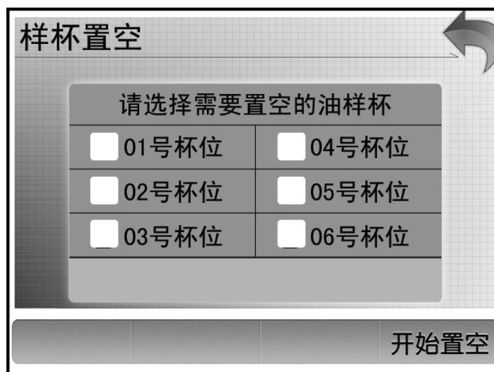
轻触按钮<01>、<02>……，该处右下角方框有“√”显示，表示仪器将要清空1号油样杯、2号油样杯……中的油样；
