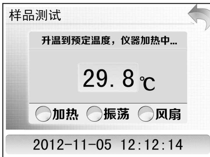
2、振荡 5 分钟，此时伴随着风扇动作，进行散热，振荡完毕后，将要静止一段时间，使其试样分层并冷却至室温。
