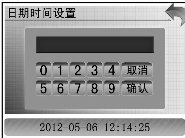
进入此界面后，空白条内会出现“20??-??-?? ??:?:??:??”字样，点击相应的数字按钮输入正确的时间，按“确认”键，修改时间并返回仪器主界面。
