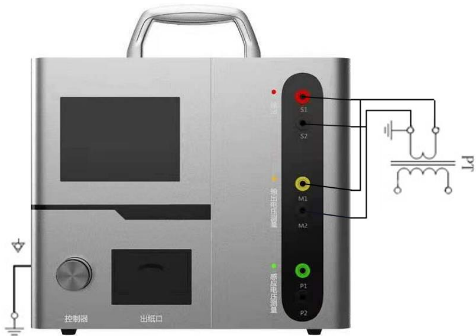
图 2.7 PT 直阻、励磁试验接线方式
