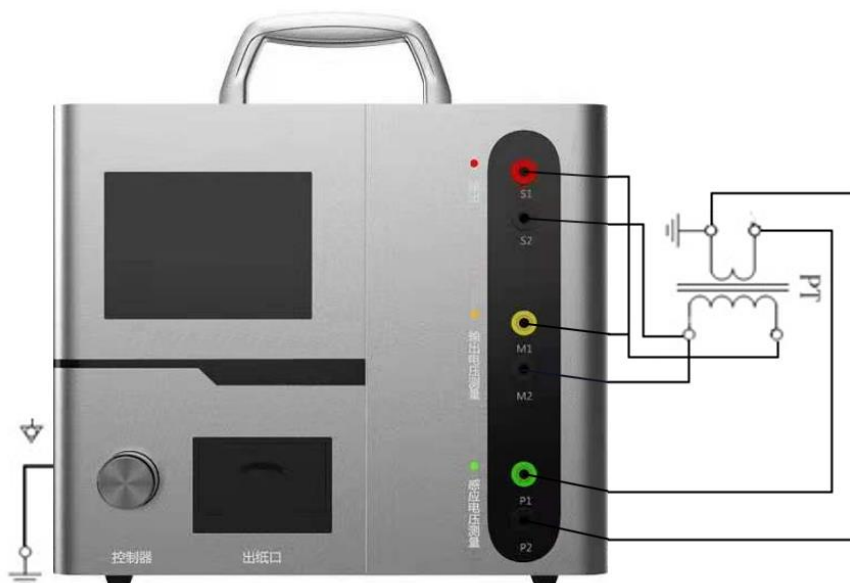
图 2.8 PT 变比、极性试验接线方式
